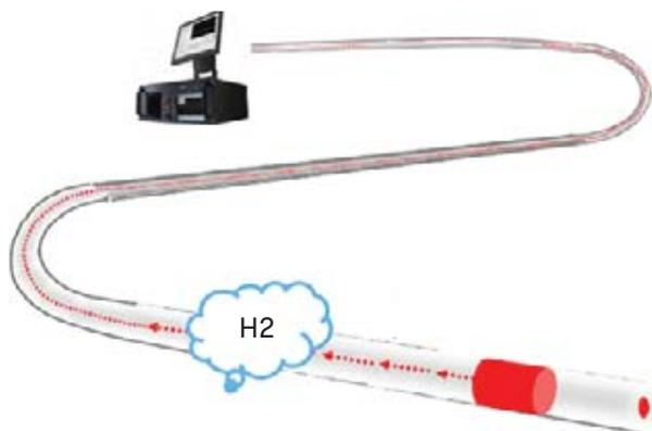
Figure 7 - Exemple graphique d'un capteur à fibre optique [Source : Modern2020]
